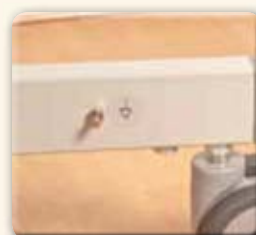
Equipotential bonding at the base frame according EN 60601.
